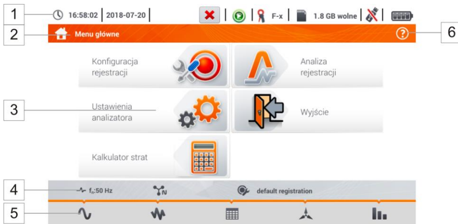
Rys. 5.2 Główne elementy ekranu rejestratora
